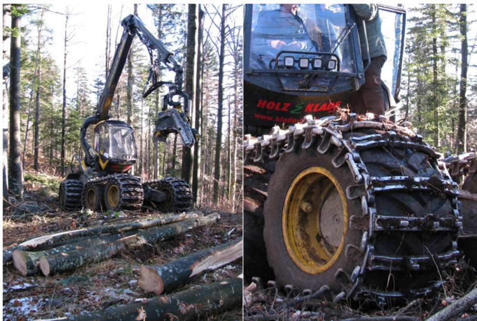
Slika 3. Polugusjenice na bogi kotačima
